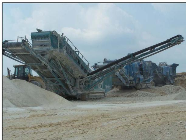
Figure 2 : Photographie de matériels de concassage et de criblage mobiles
